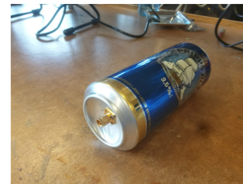
Figur 3. En Långburk med en SMA matningkontakt. Endast två skruvar används för montering för mekanisk stabilitet och elektrisk kontakt.
