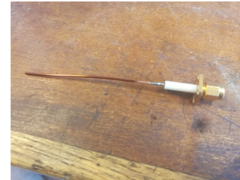
Figur 2. Centerledaren i kortburksresonatorm
