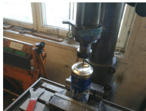
Figur 1. Borring för matarledning i långburk. På grund av den tunna plåten är fasthållningen svår.
